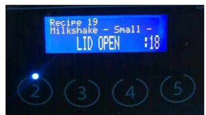
**Hinweis:** Das Öffnen der Lärmschutzhaube aktiviert den "Standby"-Modus. Der Motor stoppt. Mit dem Schließen der Lärmschutzhaube wird der Zyklus dort wieder aufgenommen, wo er unterbrochen wurde, es sei denn die Haube war länger als 30 Sekunden geöffnet.
