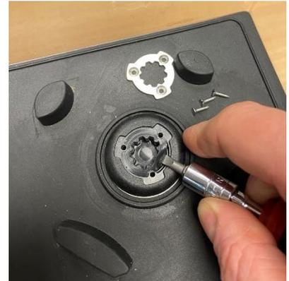
Den Motorantrieb (20) mit einer Rohrzange blockieren, die Befestigungsschraube (19) mit einem TORX-Schlüssel (gegen den Uhrzeigersinn) abnehmen.
